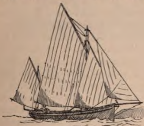
QUAY PUNT—SUMMER RIG
